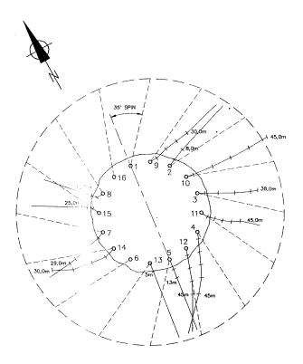
COVER HOLE DATA REQ. DIP -80° REQ. DEPTH 48m REQ. SPIN 35°
